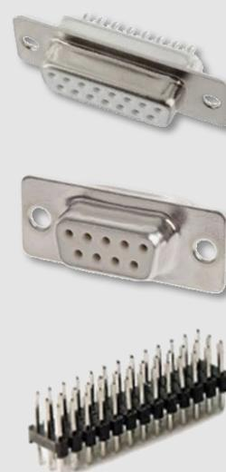
Sofern kein Lichtschrankensystem verwendet wird, sollte eine Verdrahtung auf dem D-SUB - 9 Pins (LCS von Keyence) vorgenommen werden. Dazu Pin 2 + 3 mit Pin 1 (+24 V) verbinden.
